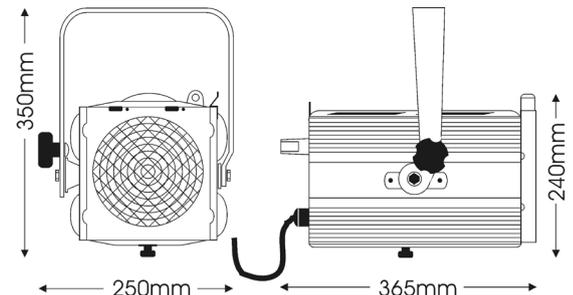
Versátil proyector fresnel para lámparas halógenas de 1000/1200W. De gama económica y, sin embargo, de alta calidad mecánica y óptica. Produce un haz ajustable y con bordes suaves.
