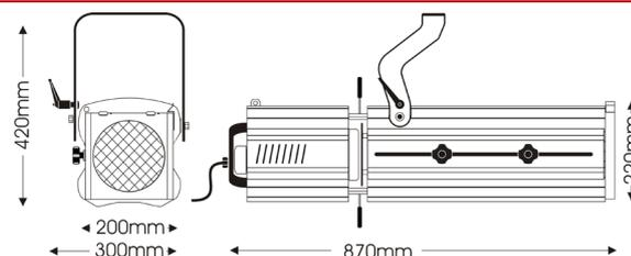
Recorte de ángulo estrecho para lámparas halógenas de 1000/1200W.
