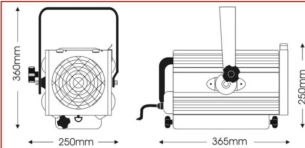
Proyector fresnel para lámpara halógena de 1000/1200W de calidad óptica extremadamente elevada.
