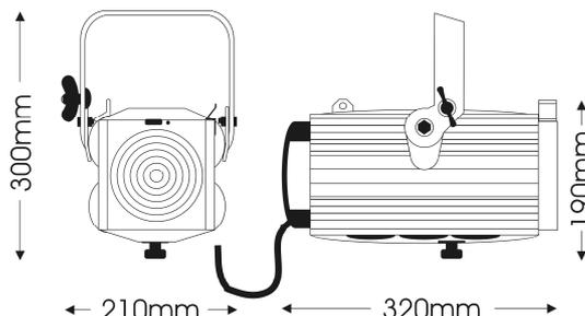
Compacto proyector fresnel para lámparas de descarga CDM-T 70W. Produce un haz muy homogéneo y con bordes suaves.
