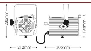
Versátil proyector fresnel para lámparas halogenas de 300/650W. De gama economica y, sin embargo, de alta calidad mecanica y óptica. Produce un haz ajustable y con bordes suaves.
