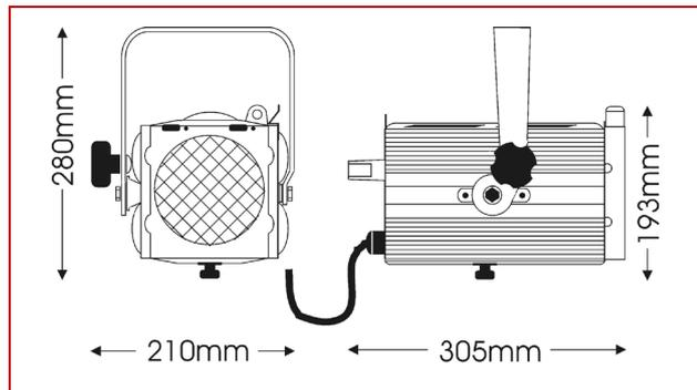
Versátil proyector plano-convexo para lámparas halógenas de 300/650W. De gama económica y, sin embargo, de alta calidad mecánica y óptica. Produce un haz ajustable entre 7° y 58°, con bordes bien definidos.
