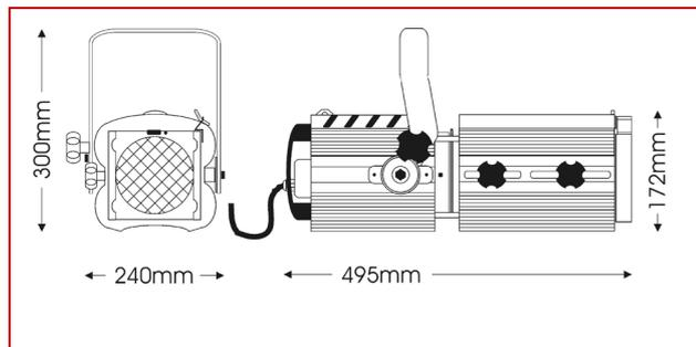
Sagomatore da 650W con sistema ottico a doppio condensatore, dall' eccellente precisione e nitida proiezione di gobo.
