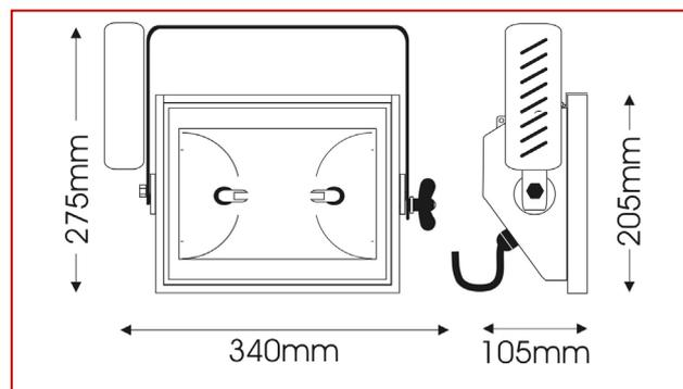
Diffusore simmetrico per lampade a scarica CDM-TD da 150W, ideale per utilizzo in tutte quelle applicazioni di tipo architettonica (vetrine, show room, stand fieristici) dove si richiedano luce in diffusione intensa ed, al contempo, di lunga durata e con limitatissimi consumi.
